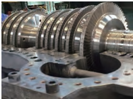
蒸気タービン（内部・羽根）
