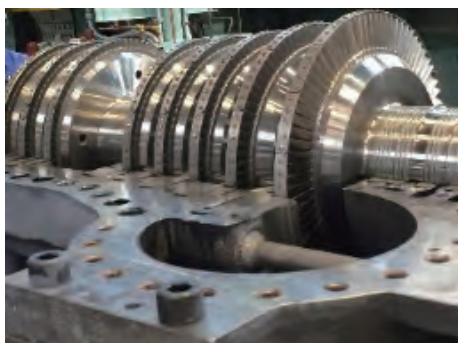
蒸気タービン (内部・羽根)
