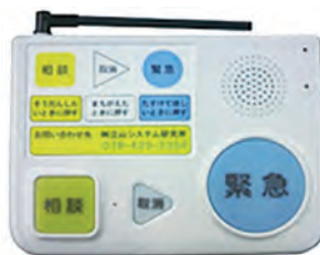
緊急通報装置本体
