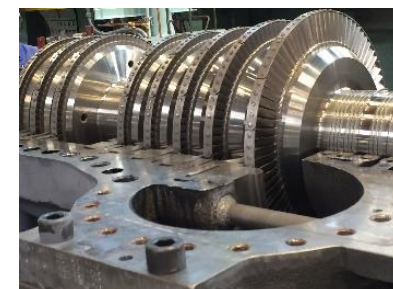
蒸気タービン内部 (羽根)
