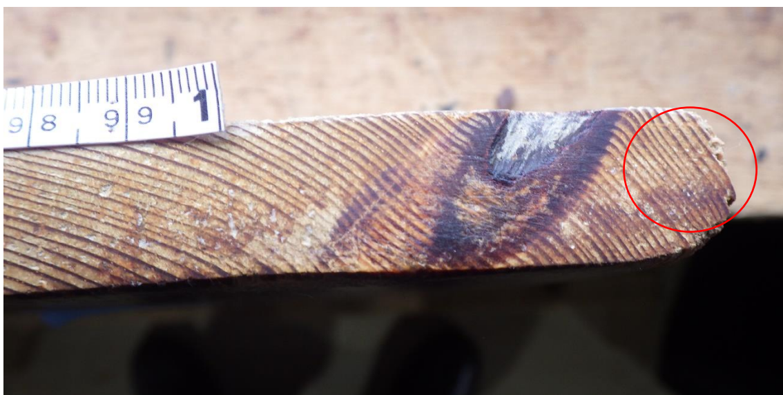
写真 2 床板の年輪画像（木口）（○印のなかに樹脂道が散点状に分布）
