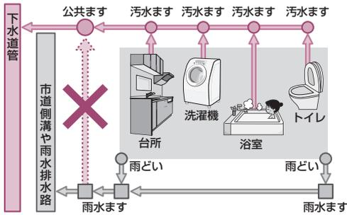
市は下水道は「分流式下水道」という方式を採用しています。これは、台所や風呂、トイレなどの生活排水のみを「汚水」として下水道管に流し、建物や敷地に降った雨（雪）は下水道管に流さず、市道側溝や雨水排水路に流すものです。
