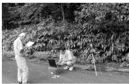
空間放射線量率の測定作業
