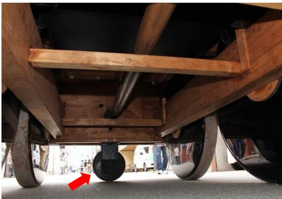
戻し車(前輪を持ち上げ方向転換する)
