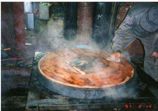
輪締め(鉄輪を収縮させる)
