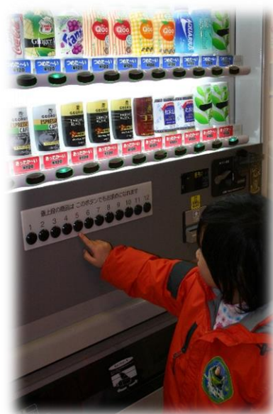
誰もが使用しやすい位置にボタンやお金の投入口がある自動販売機
