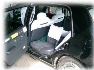
座席が回転し、乗降しやすいサポートシートを設置したタクシー
