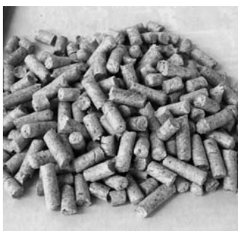
間伐材などを活用したペレット燃料。バイオマスの一つ
