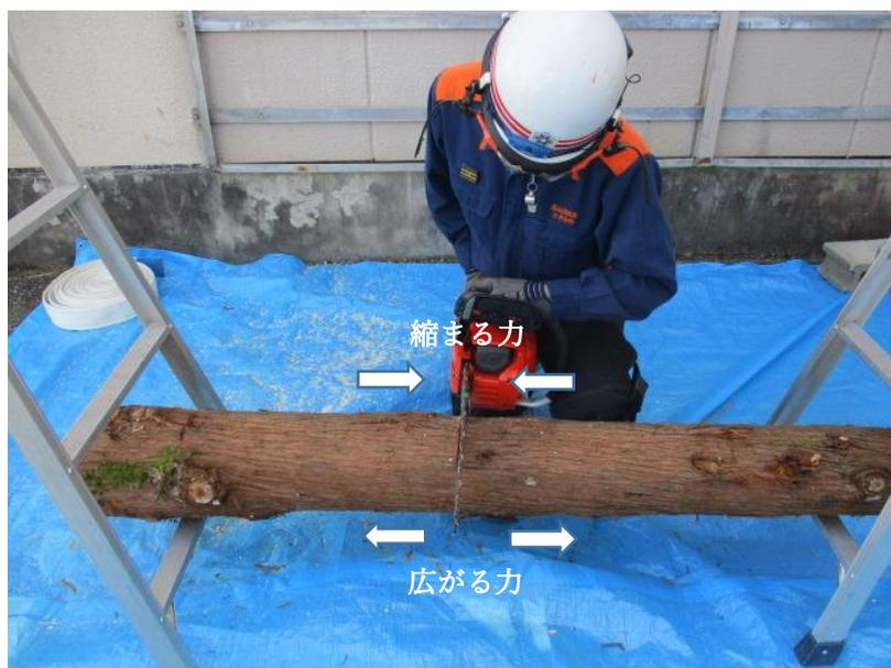
橋状の材は、①木材の上から 3分の1 程度切断する、②木材の下から切り上げ切断する。
