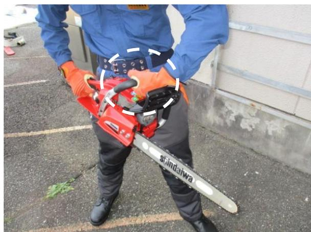
作動させるには左手の手首を内側にひねるように動かし、手の甲を押し当てレバーを前方に倒します。
