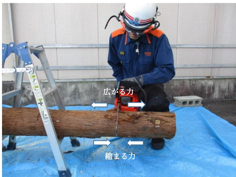
片持ちの材は、①木材の下から 3分の1 程度切断する、②木材の上から切り下げ切断する。
