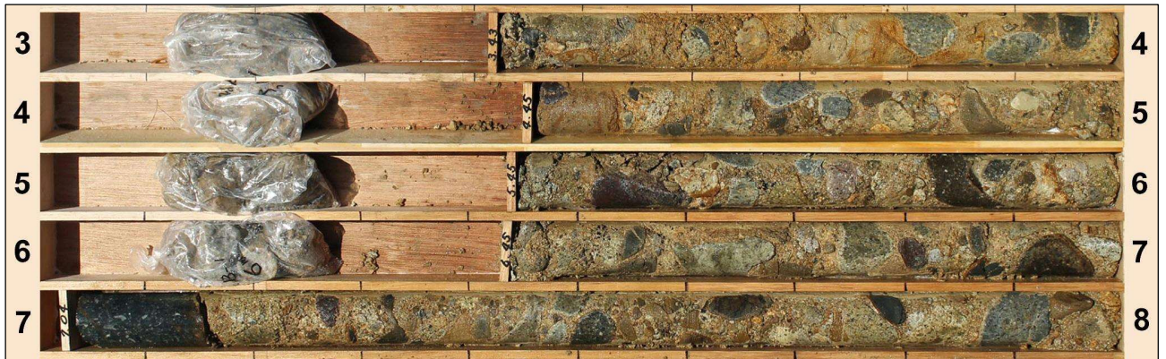
写真4.1.3 No.B-1地点のAg2層のコア写真抜粋 (GL-4～8m)
