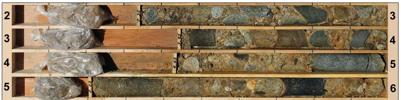
写真4.1.4 No.B-2地点のAg2層のコア写真抜粋 (GL-2～6m)
