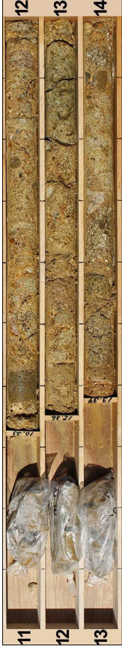
写真1.2.5 No.B-2地点のDg層のコア写真抜粋 (GL-11～14m)
