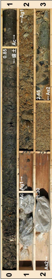
写真1.2.1 No.B-1地点の盛土、Ac層、Ag1層及びAs2層のコア写真 (GL-0～3m)
