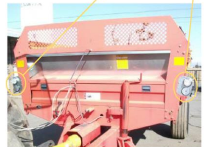
後部反射器及び灯火類の設置例
