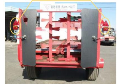
後部反射器及び灯火類の設置例
