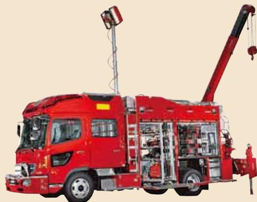
救助工作車が導入後21年を経過したため更新。新たにクレーン装置、ガス溶断器、化学剤検知器を装備し、さまざまな救急事案への対応が可能となる。
