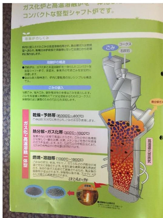
**[4] ゴミの熱エネルギーで発電や場内給湯を行っており、発電した電力は場内機器の動力や照明などに使用し、余剰電力は電力会社に売電している。**
