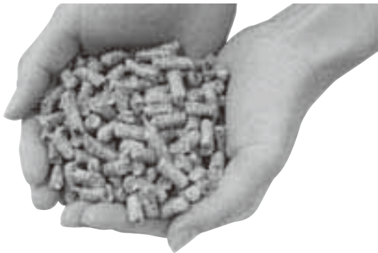
バイオマス燃料の一つであるペレット燃料。ペレットとは英語で「小さい塊」の意。間伐材や木くずなどを小さく固めて作ります
