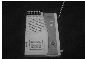
緊急地震速報受信機 (館内放送接続型)
