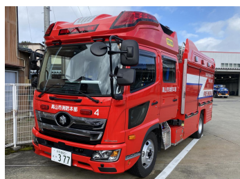
水槽付ポンプ自動車（大野分署）
